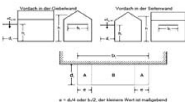
Bild 1 — Abmessungen und Einteilung der Flächen für Vordächer
