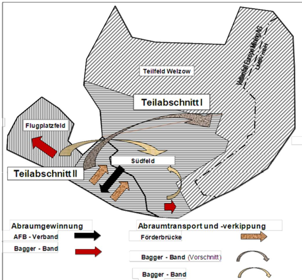
Abbildung 2: Räumliche Entwicklung der Durchführung der Braunkohlenpläne - Abbauentwicklung (Gewinnung, Transport und Verkipfung)
