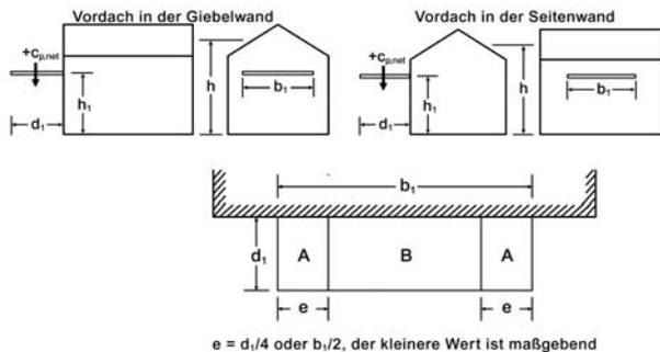
Bild 1 — Abmessungen und Einteilung der Flächen für Vordächer
