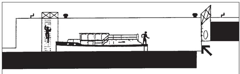
Wenn Sie eine Leine mit der Hand führen, legen Sie ihr Ende immer um eine Klampe an Bord, um das Boot auch bei starker Belastung noch halten zu können – Verletzungsgefahr: Quetschungen –.
