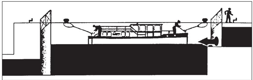
Nach Erlaubnis zur Ausfahrt Leinen einholen; darauf achten, dass keine Leine ins Wasser fällt und in die Schraube gerät. Langsam und vorsichtig ausfahren.
