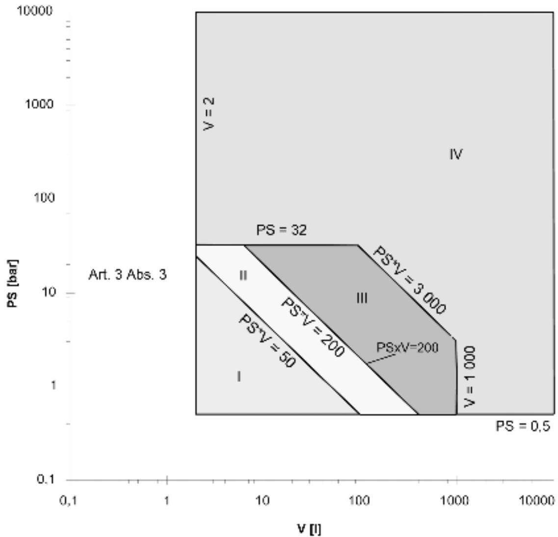
**Befeuerte** oder **anderweitig beheizte überhitzungsgefährdete Druckgeräte** zur Erzeugung von Dampf oder Heißwasser mit einer Temperatur von mehr als 110 °C und einem Volumen von mehr als 2 Litern sowie alle Schnellkochtöpfe.
